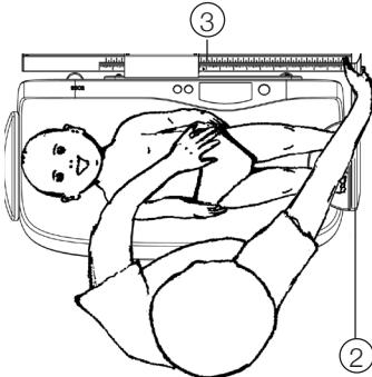
2. Työnnä jalkatukea (2) oikealla kädellä vauvan jalkojen suuntaan ja nostaa vauvan jalat jalkatuen pääälle. Kiinnitä vauva vasemmassa kädellä vaa'an kaukaloon.
