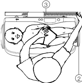
2. Med höger hand flyttar man fotstödet (2) mot spädbarnets fötter och placera fötterna på fotstödet. Med vänster hand håller man fast spädbarnet på vågskålen.
